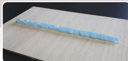
Bild a: Klebstoff im frischen Zustand ist hellblau
