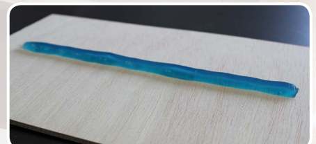
Bild b: Klebstoff nach Aushärtung ist blau-transparent
