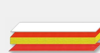
1 Технически оптимизированные однокомпонентные полиуретановые клеи для склеивания поверхностей COSMO® PU-160.540 и COSMO® PU-160.530 для склеивания и производства боковых панелей автодомов и трейлеров.
