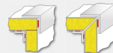
1 Контролируемый двухкомпонентный конструкционный клей на основе силлил-модифицированного полимера COSMO® HD-200.101 для операций склеивания и герметизации в производстве транспортных средств и их кузовов.
