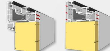
1 Контролируемый двухкомпонентный конструкционный клей на основе силлил-модифицированного полимера COSMO® HD-200.101 для соединения полотна и профильной системы.
