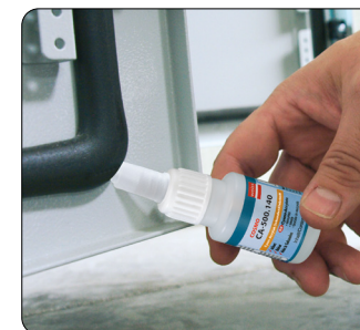
Verklebung von Türdichtungen
