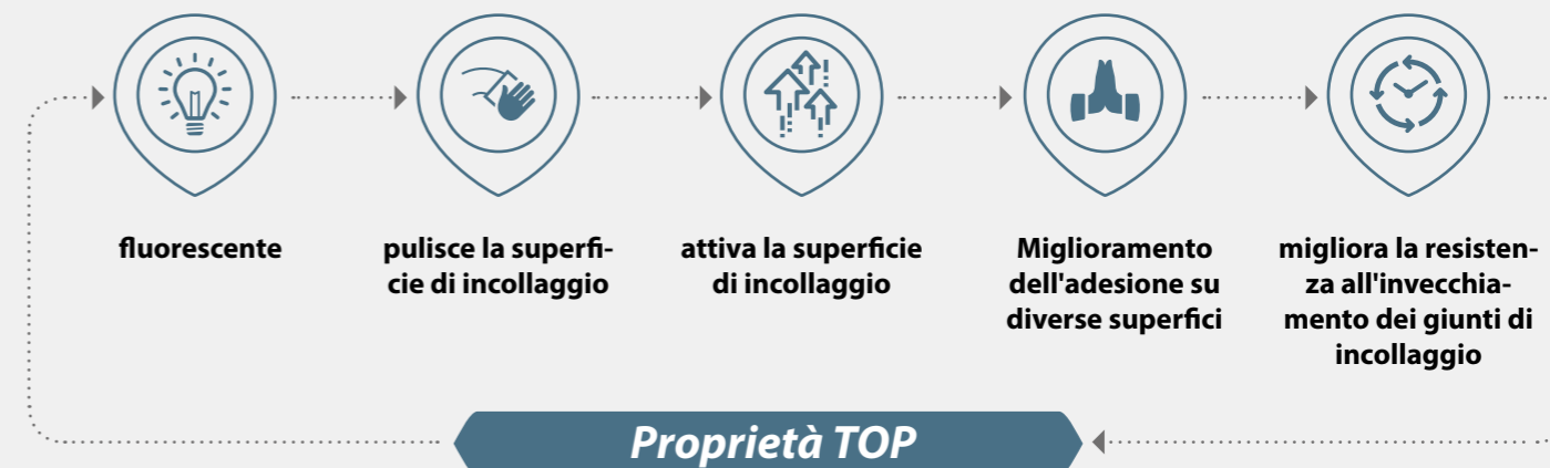
"Raggi UV" controllo completo del processo, chiara visualizzazione del pretrattamento tramite ingrediente fluorescente.
