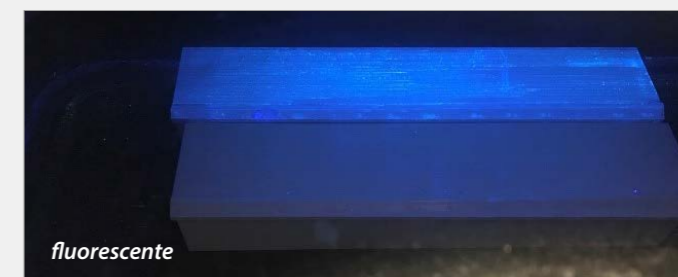
"Raggi UV" controllo completo del processo, chiara visualizzazione del pretrattamento tramite ingrediente fluorescente.
