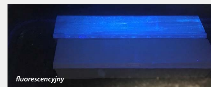
„czarne światło” pełna kontrola procesu, przejrzysta wizualizacja obróbki wstępnej za pomocą składnika fluorescencyjnego
