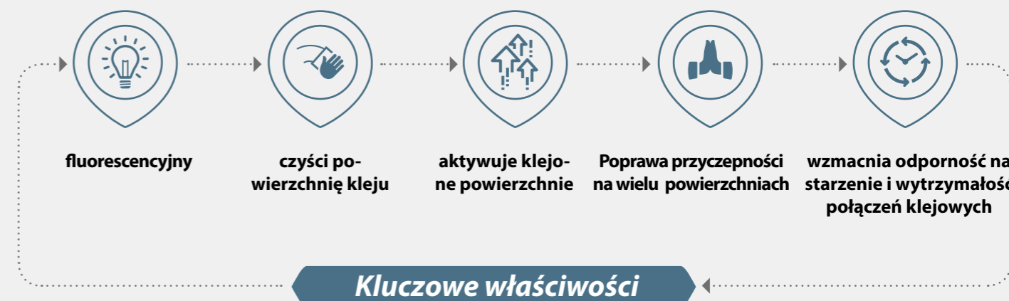
„czarne światło” pełna kontrola procesu, przejrzysta wizualizacja obróbki wstępnej za pomocą składnika fluorescencyjnego
