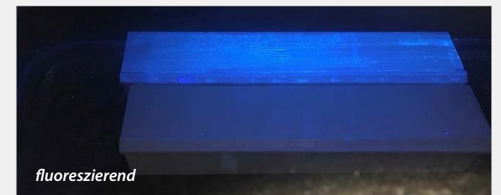
„Schwarzlicht“ volle Prozesskontrolle, klare Visualisierung der Vorbehandlung durch fluoreszierenden Inhaltsstoff.
