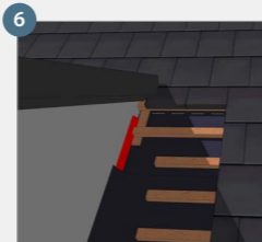
6 Collage et étanchéification des écrans de sous-toiture dans la zone des lucarnes avec p.ex. COSMO® HD-110.110
