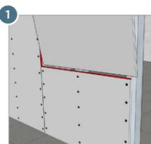
1 (Стыковые) шовные клеевые соединения панелей гипсокартона при монтаже на стены
