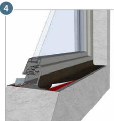
Подготовка основания для самоклеящихся уплотнительных лент в оконных и дверных проемах с использованием, например, **COSMO® SP-830.180** для монтажа согласно нормам RAL
