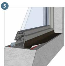
Приклеивание наружных уплотнительных лент к оконным и дверным приемам с использованием, например, **COSMO® HD-100.510** для монтажа согласно нормам RAL
