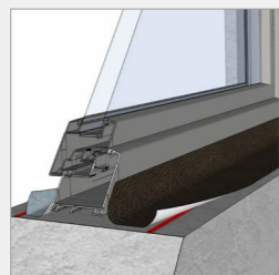
Cintas cubrejuntas para la instalación de puertas y ventanas en «exterior»
