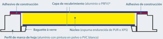
\*Si el panel montado sobre el borde se corta a medida, los bordes resultantes en la capa de recubrimiento deben protegerse de la corrosión y sellarse de acuerdo con los últimos avances técnicos (p. ej., mediante imprimación y pintado).
