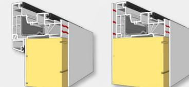
1 El adhesivo de construcción de **STP bicomponente controlado COSMO® HD-200.101** para la unión de capa de recubrimiento y bastidor de perfil.
