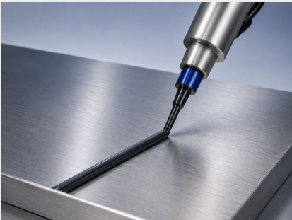
Aplicación de cordón
